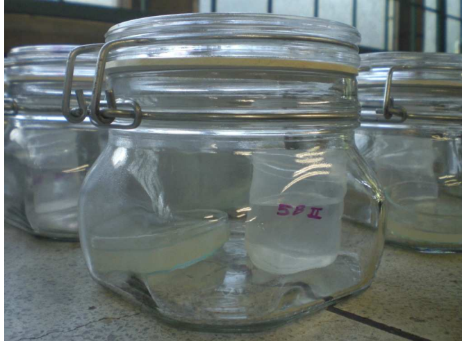
Figura 4.1. Aspecto de la cámara usada para evaluar la producción microbiana de CO 2 . Nótese en el interior la caja de Petri con el medio de cultivo (carboximetil-celulosa como fuente de C) y el beaker con NaOH que actúa como trampa del CO 2 .
