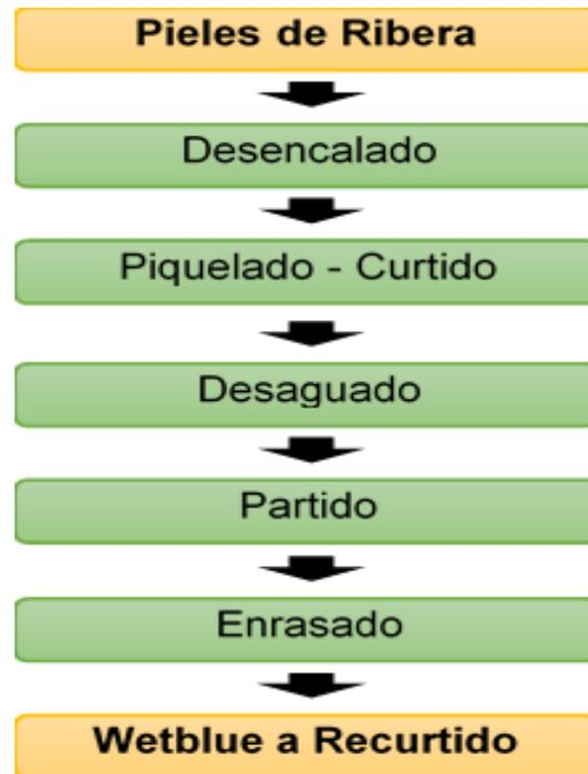
*Figura 9.* Diagrama general del Subproceso de Curtido. Fuente: Lorber, et al., 2007, pág. 67.
