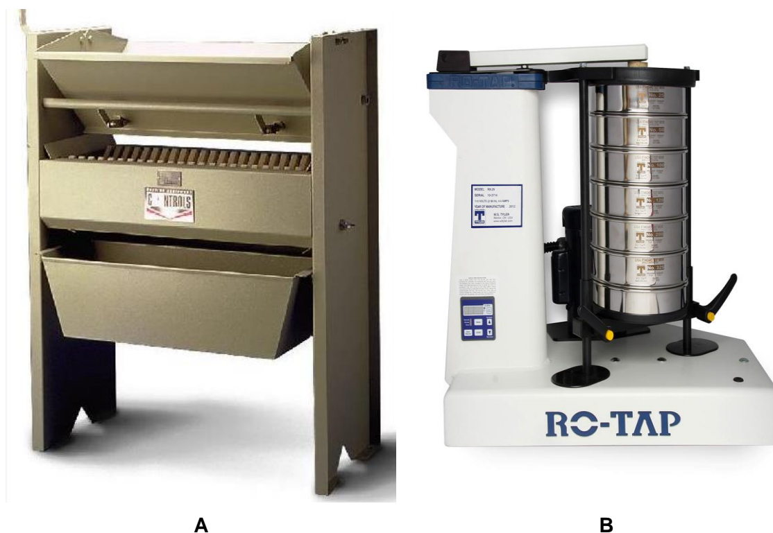
Figura 1. Equipos de separación y tamizaje: (A) Cuarteador Splitter Sample, (B) Ro-Tap con mallas Tyler.
