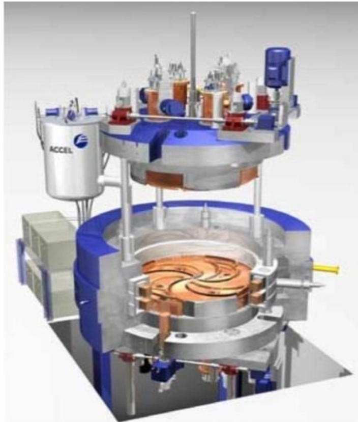
Figura 2-10 Ciclotrón superconductor de 250 MeV (Tomado de [44])
