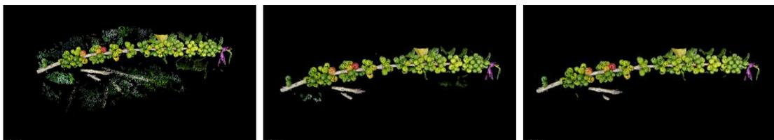
(a) Nube de puntos de entrada. (b) Filtrado de *Outliers*. (c) Remoción de fondo.**Figura 3-17:** Resultados del proceso de filtrado de la rama No. 2
