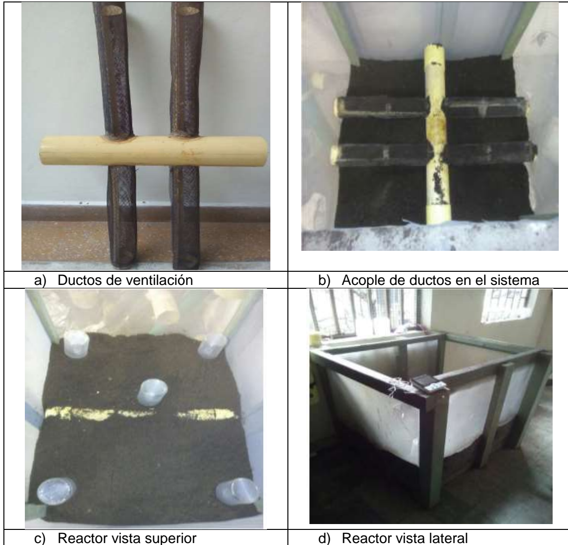
Figura 10. Montaje del reactor de lecho estático de aireación pasiva
