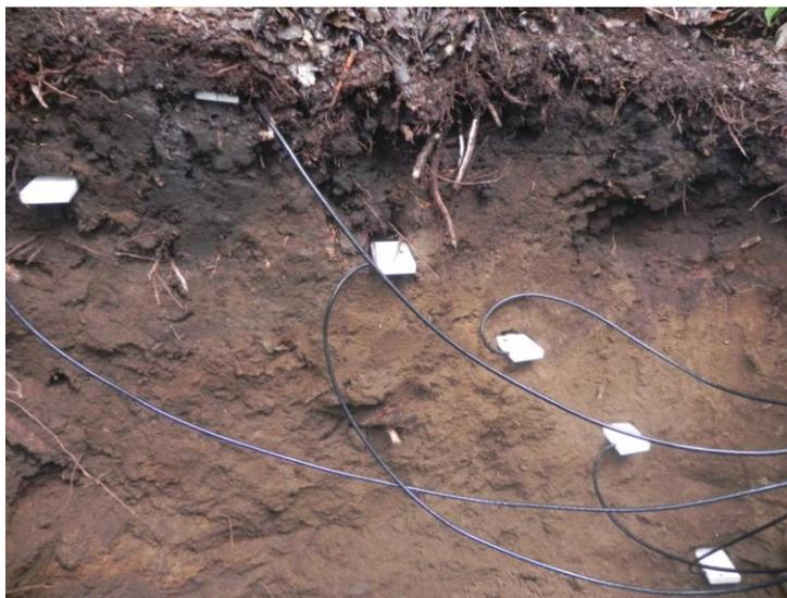
**Figura 4-2:** Ejemplo de distribución de los sensores de humedad en el perfil del suelo.
