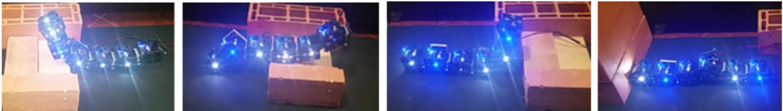
FIGURA 5.4. Fotogramas de la estructura de seis (6) módulos evadiendo un obstáculo en forma de escalera.
