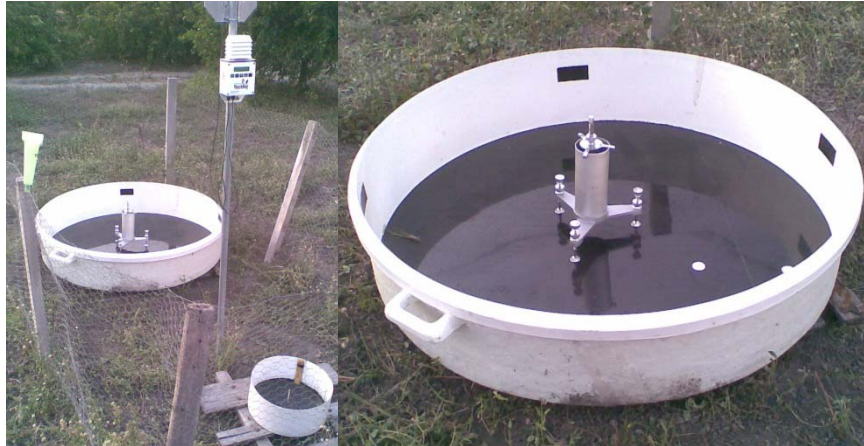
Figura 6. Instalación de tanque evaporímetro Clase A.
