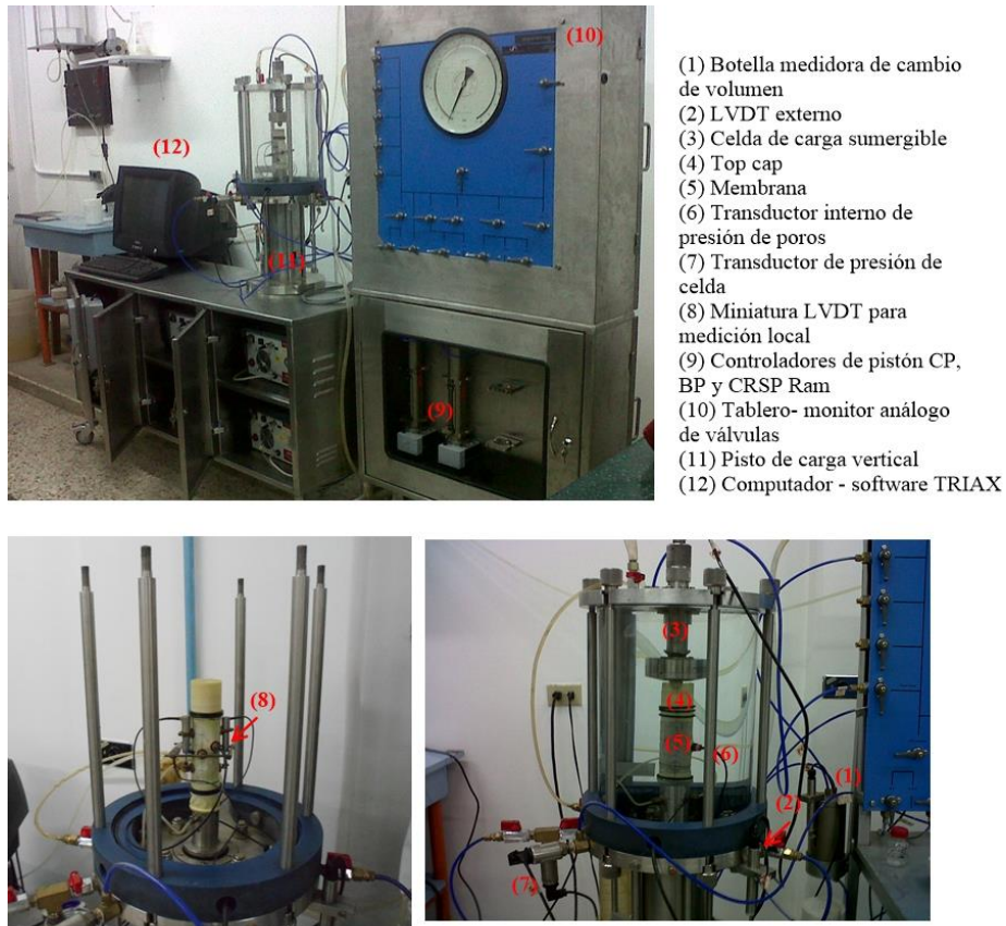
Figura 4-4: descripción de equipo triaxial de trayectorias. Fuente: elaboración propia.
