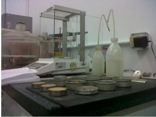
Fotografía 3-1: muestras usadas en los ensayos de límites: líquido, plástico y de contracción (Laboratorio de Geotecnia de la Universidad Nacional de Colombia – Sede Bogotá)
