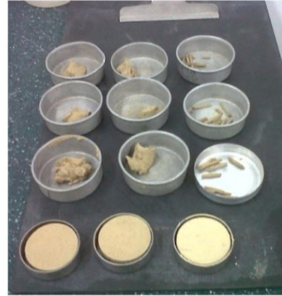
Fotografía 3-1: muestras usadas en los ensayos de límites: líquido, plástico y de contracción (Laboratorio de Geotecnia de la Universidad Nacional de Colombia – Sede Bogotá)
