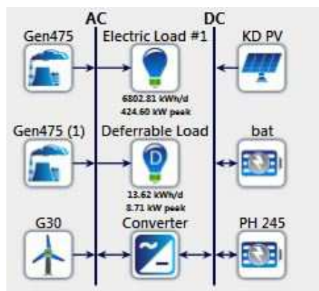
Figura 6-4. Esquema de microrred implementada en HOMER. Caso 3.
