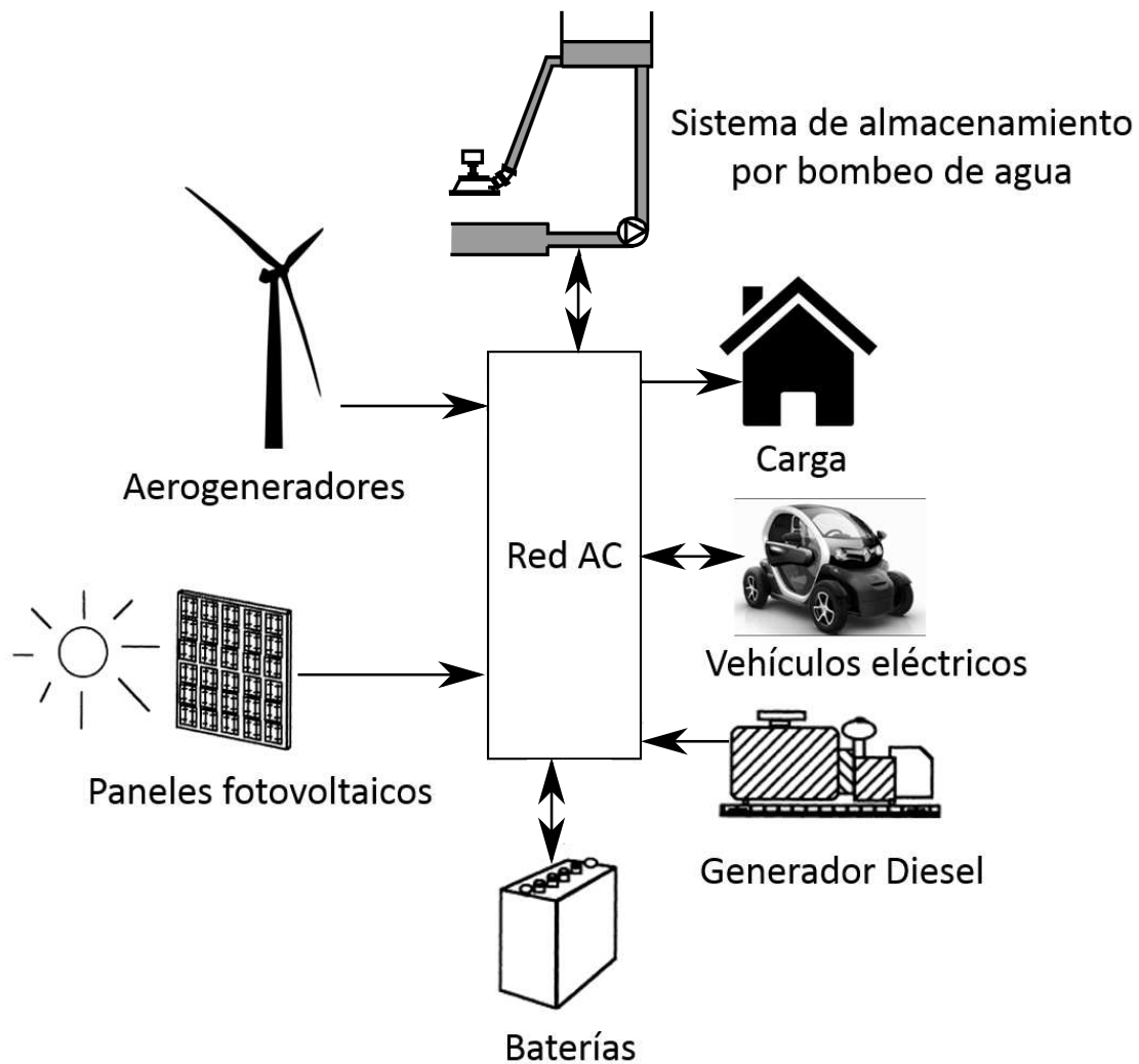
Figura 3-2. Esquema de la microrred híbrida aislada.
