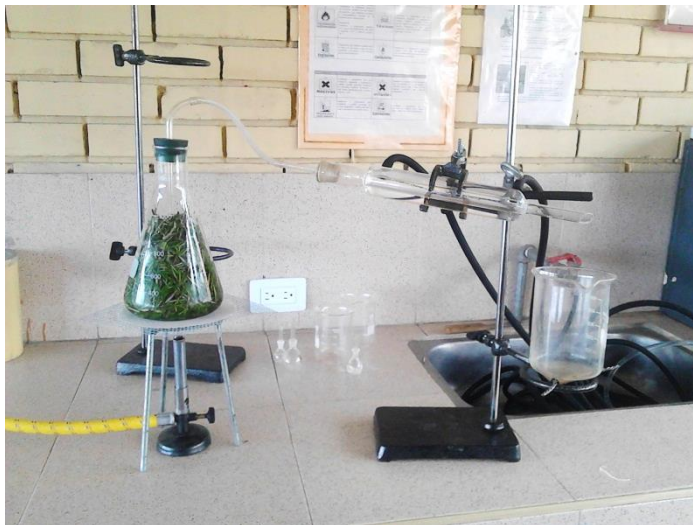
Figura 4-2: Montaje hidroddestilación Actividad 6 - Semana 1
