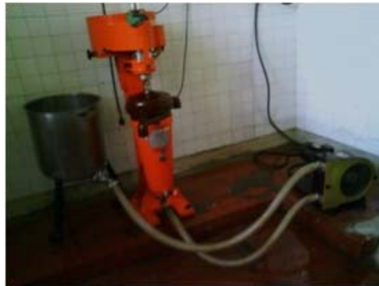
Figura 3-2: Montaje para la separación de aceite
