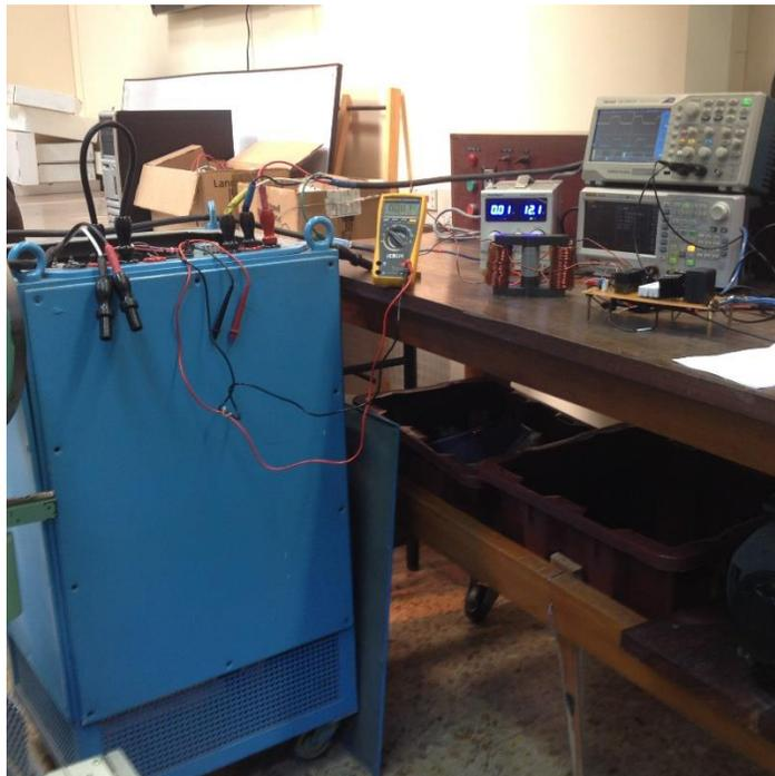
**Figura 3-15:** Conexión del prototipo final con la fuente de alta potencia y el arreglo de resistencias
