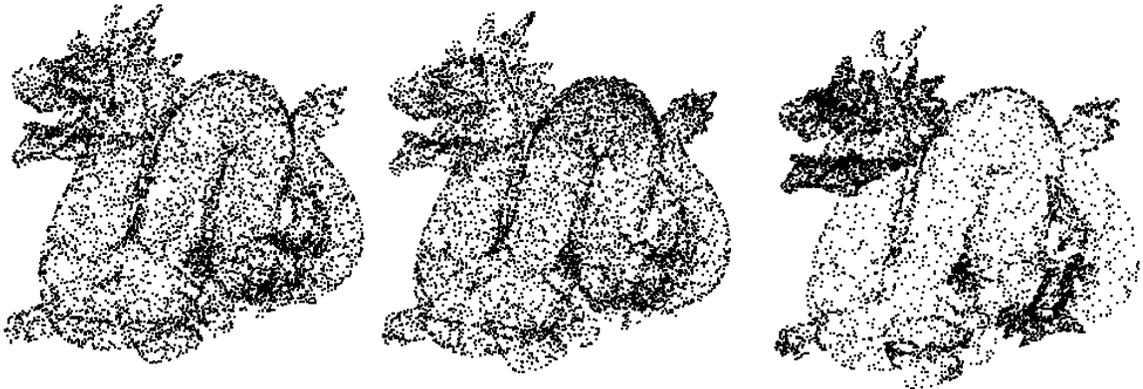
Figura D.1. Modelo de dragón de la Universidad de Stanford. El modelo fue muestreado con la Técnica I, II y III respectivamente, las tres nubes de puntos tienen 8753 puntos, lo cual corresponde al 2% del total de puntos.
