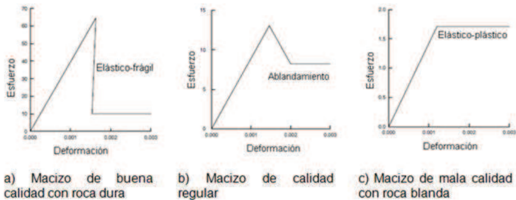
Figura 2. Características de falla para macizos rocosos de diferente calidad y comportamiento. Note que las escalas de esfuerzos son diferentes. Modificada de Hoek (1997)
