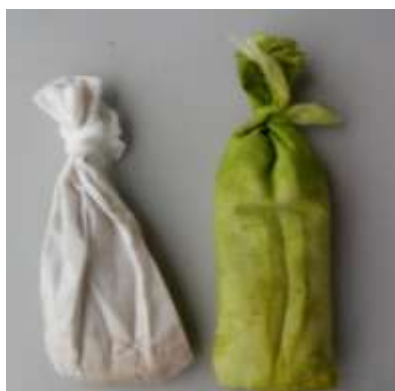
Figura 14. Lechos empacados antes y después de la extracción
