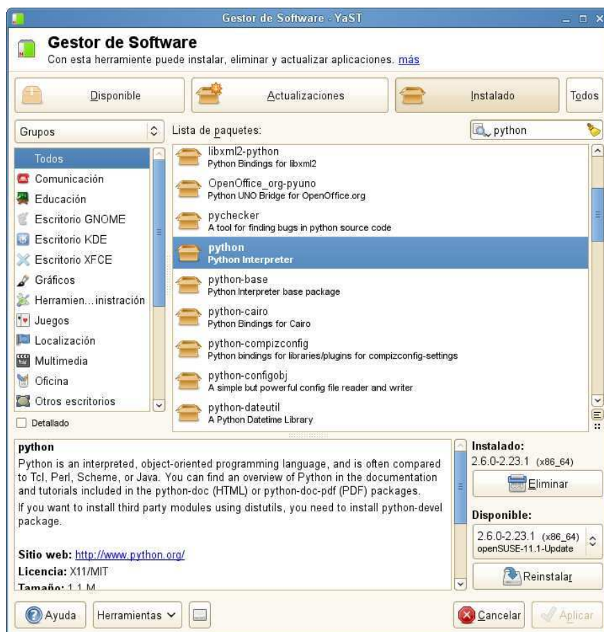
Figura A.1: Selección de python en el Administrador de paquetes OpenSUSE 11.1 (YaST)
