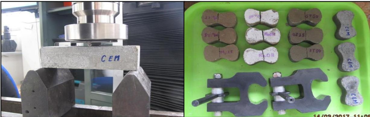
**Figura 21** Ensayos a flexión y tensión
