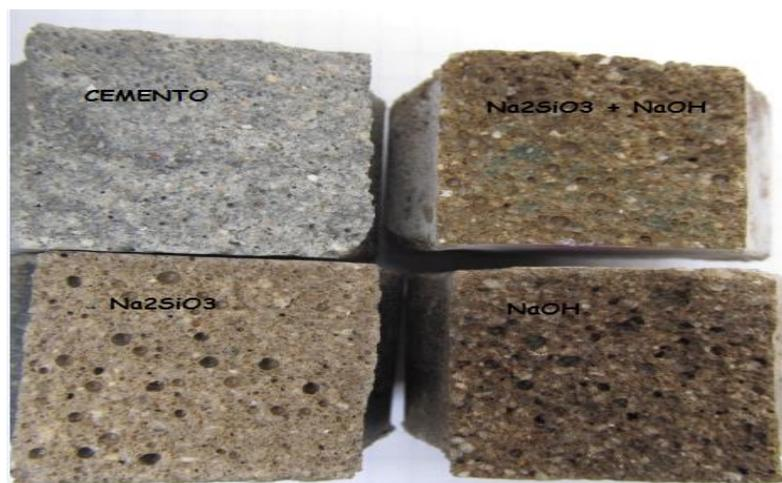
*Figura 26* Secciones de las probetas utilizadas en el ensayo de tensión.
