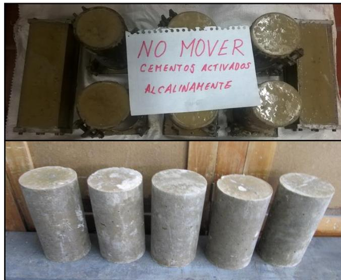
**Figura 20** Cilindros de concreto activados alcalinamente
