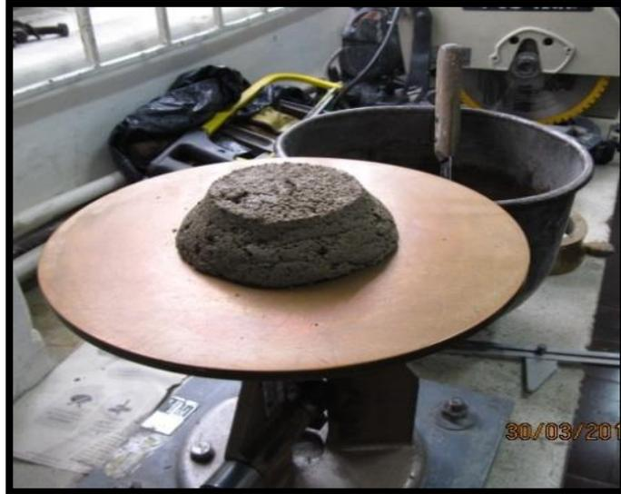
**Figura 19** Aspecto del tronco de cono del mortero  $\text{Na}_2\text{SiO}_3$
