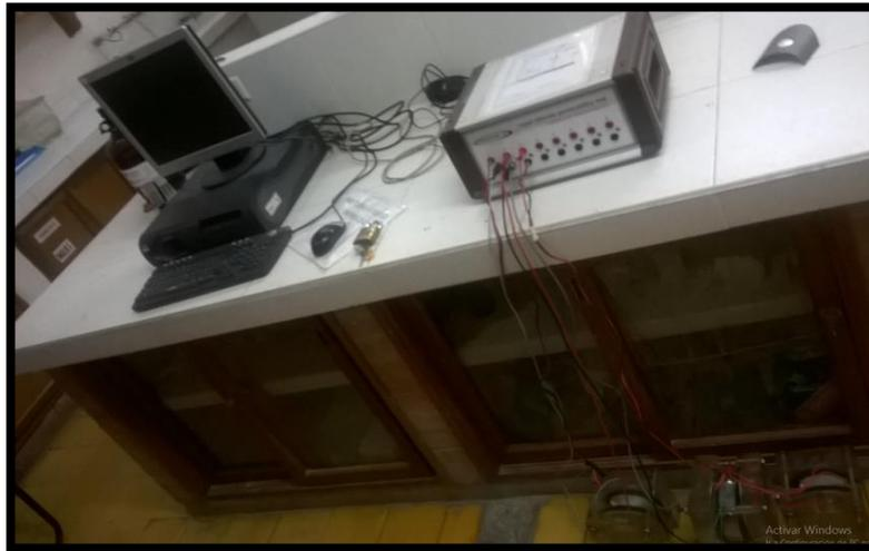
**Figura 23** Ensayo RCPT
