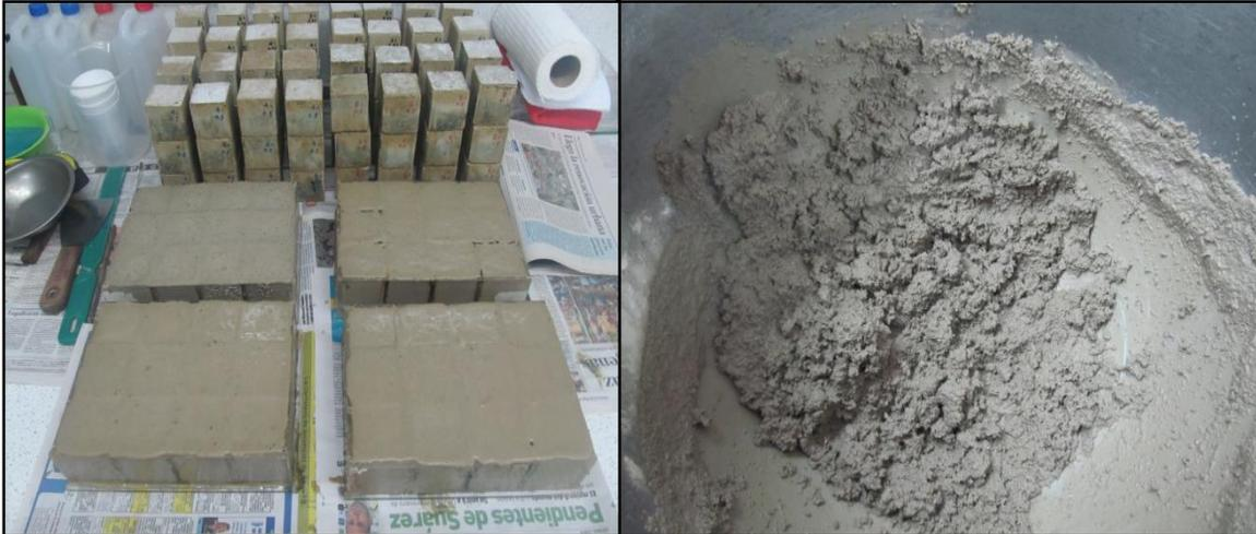
**Figura 18** Moldes, cubos y mortero
