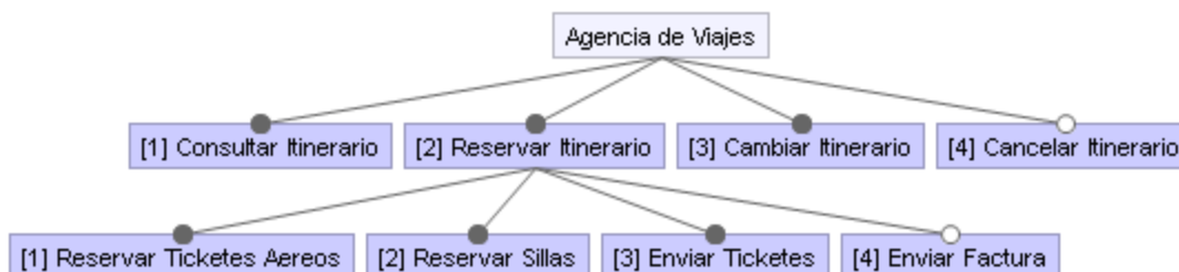
Figura 4-14: Modelo de características de una línea de procesos de negocio para agencias de viajes diseñada por medio de FeatureIDE [25].
