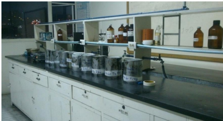
Figura 17. Preparación de asfaltos modificados para las realizacion de pruebas Marshall
