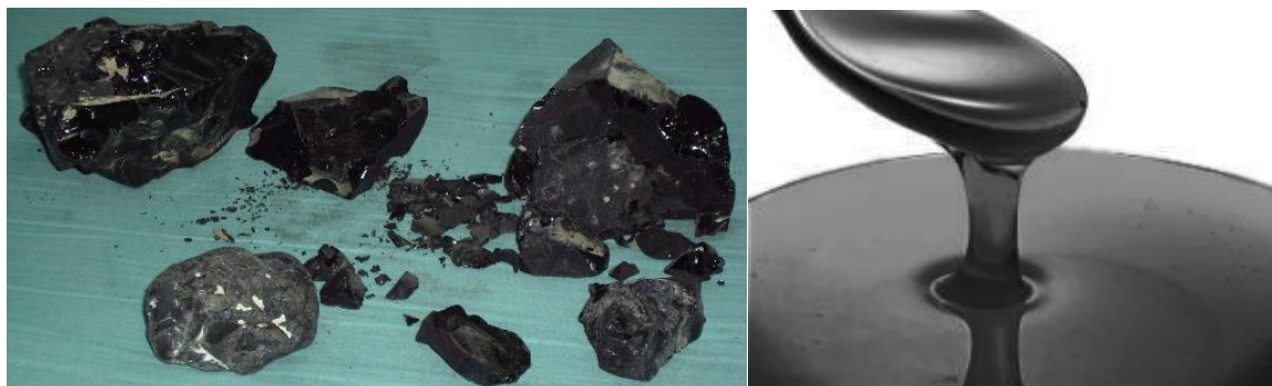
Figura 5. Estado del asfalto a diferentes temperaturas Izquierda sólido T < 25\text{ }^{\circ}\text{C} y Derecha en estado líquido T > 60\text{ }^{\circ}\text{C}
