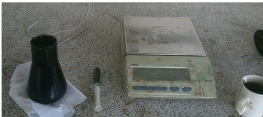
Figura 15. Preparación de los asfaltos modificados con aceite usado
