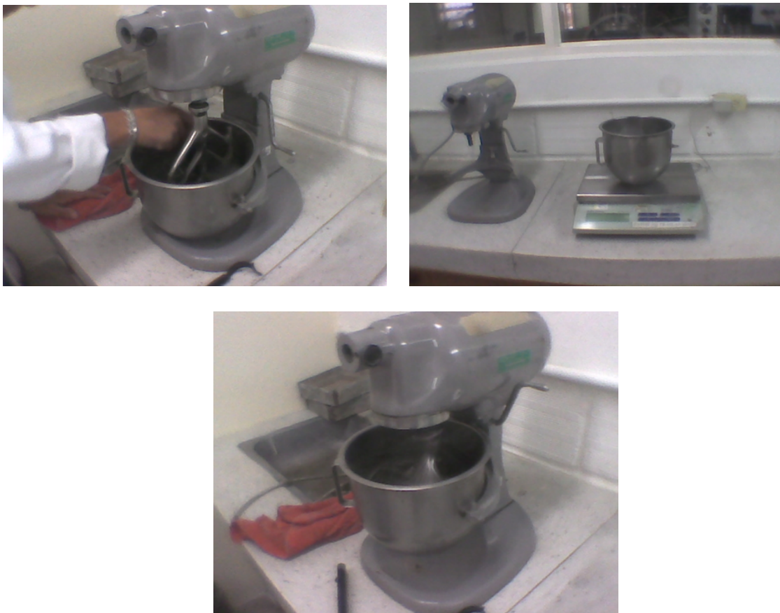
Figura 9.1 Equipo usado para la mezcla de pasta de cemento
