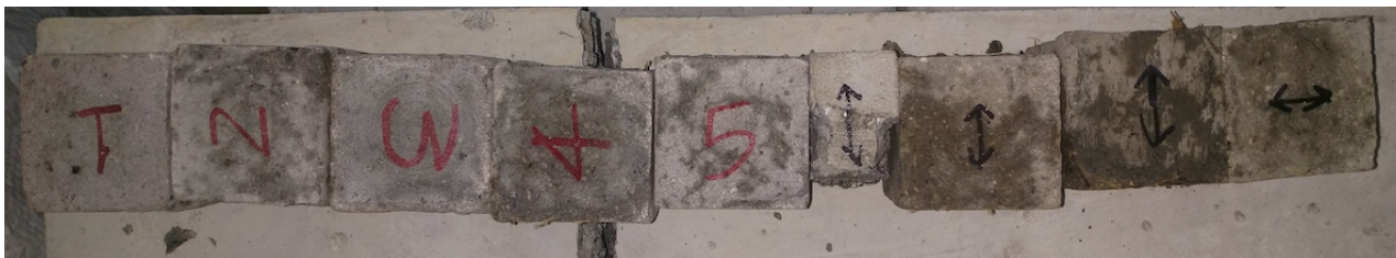
Figura 10.4 Estado de cubos de mortero de 5*5*5 cm adicionados con fibras de bagazo de caña (BC) y raquis de palma (PA) en porcentajes: 0.5% y 1% una vez sometidos a esfuerzo de compresión.
