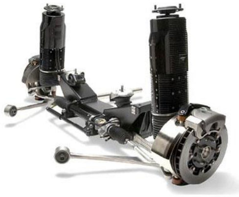
Figura 2- 8: Suspensión Electromagnética BOSE [7]
