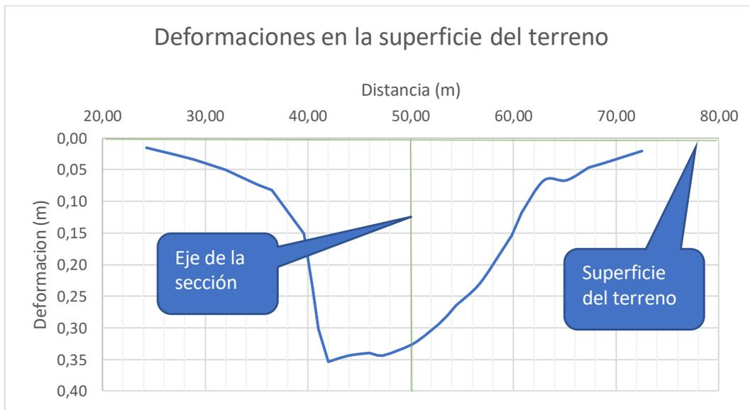
**Figura 47.** Nivel de deformaciones generadas en la superficie del terreno mediante el método Cam clay
