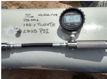
FOTO 9: Prueba de adherencias 2838 psi, falla pegante 100%
