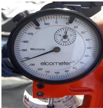
FOTO 3: Medición de perfil de anclaje
