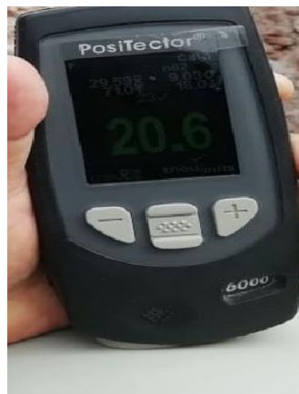
FOTO 6: Medición de espesores
