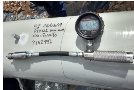
FOTO 10: Prueba de adherencias 2162 psi, falla pegante 100%
