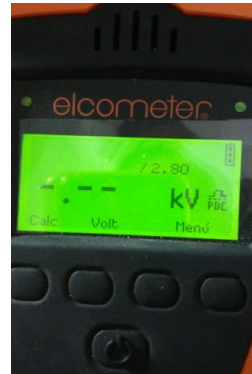
FOTO 12: Pruebas de discontinuidad, sin detección de porosidad.
