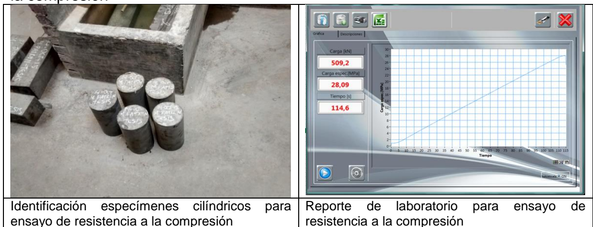
Figura 12. Identificación de especímenes cilíndricos y reporte ensayo resistencia a la compresión
