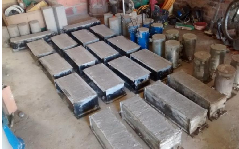
Figura 6. Muestras de concreto con adición de fibra Sikafiber AD
