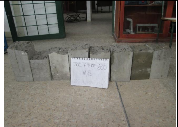
Fallas de vigas prismáticas muestra F1-I-T-5
