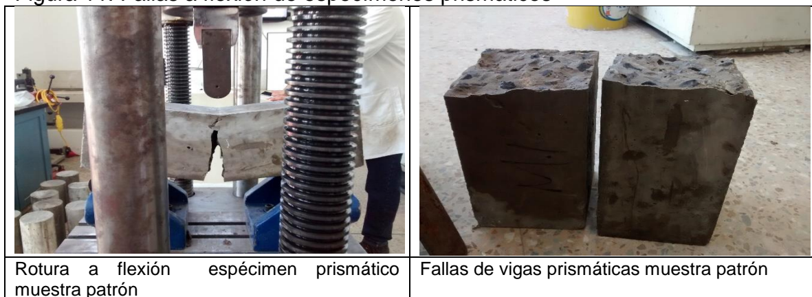
Figura 11. Fallas a flexión de especímenes prismáticos
