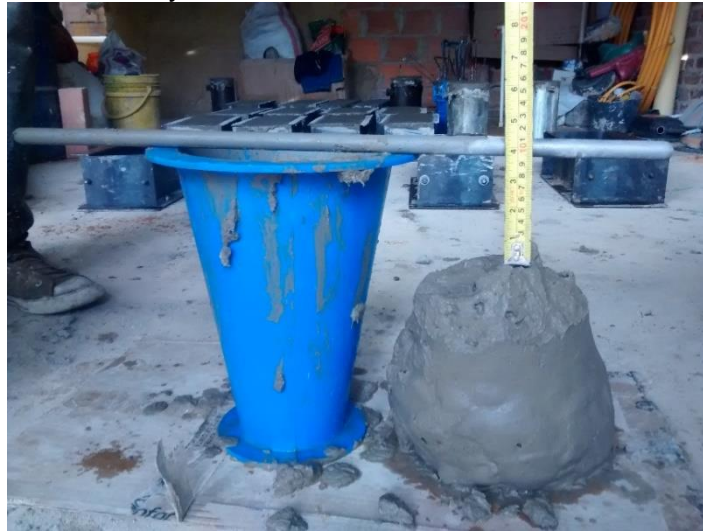
Figura 5. Medición del ensayo de asentamiento en las muestras de concreto
