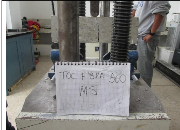
Rotura a flexión espécimen prismático muestra F1-I-T-5 (Toc fibra 500)
