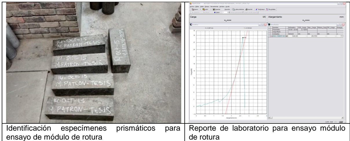
Figura 10. Identificación de especímenes prismáticos y reporte ensayo módulo de rotura
