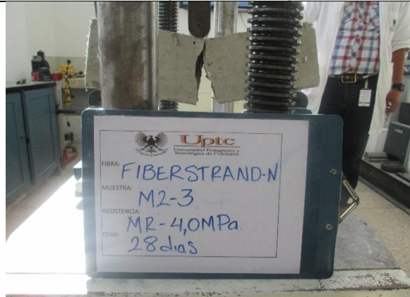
Rotura a flexión espécimen prismático muestra F1-I-N-2 (Fiber Strand N)
