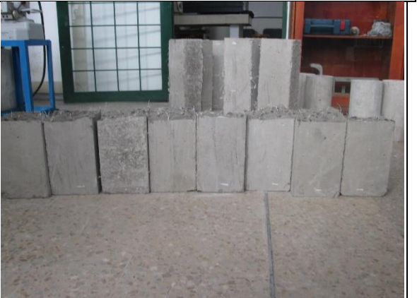
Fallas de vigas prismáticas muestra F1-I-SF-3
