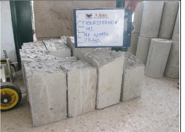
Fallas de vigas prismáticas muestra F1-I-N-2
