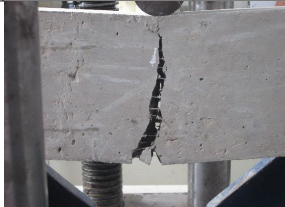
Rotura a flexión espécimen prismático muestra F1-I-SF-3 (Tuf Strand SF)
