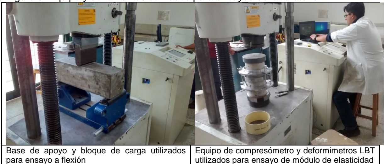
Figura 9. Equipo y aditamentos utilizados para ensayos de laboratorio
