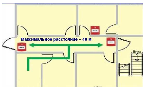
Рис. 4. Схема расположения ручных пожарных извещателей на анализируемом объекте
