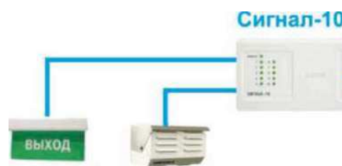
Рис. 5. Схема СОУЭ на анализируемом объекте
