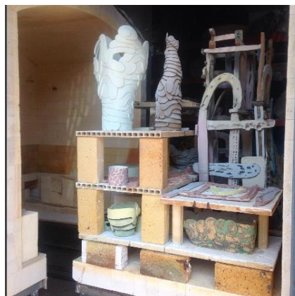
Figura 8: Registro fotográfico do forno no qual Luke Armitstead queima as suas esculturas de argila. Fonte:
