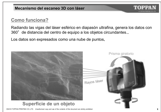
Fig. 10. Equipo del escaneo 3D con láser FARO Focus 3D X330HDR (Cortesía de Toppan Printing, Co. Ltd.)
