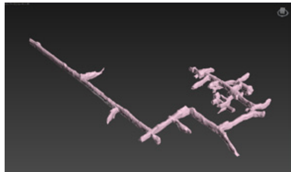
Fig. 14. Red de túneles después de la poligonización.
