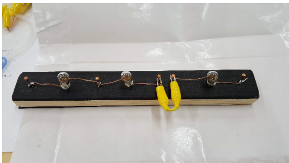
図5 自作した豆電球の実験セット。背面には磁石がついており、黒板で演示が可能である。
