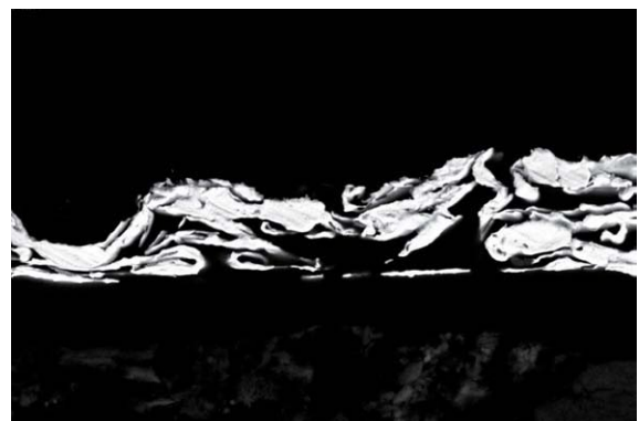
図 99 描金部分の漆断面 (SEM)
