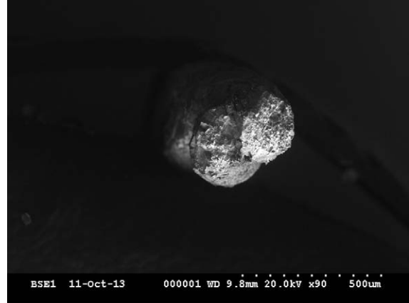
図 85 2本を撚り合わせた金属線 (SEM)
