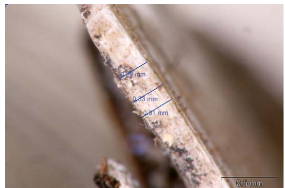
図 69 螺鈿文様の断面
