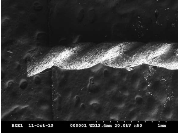
図 84 2本を撚り合わせた金属線 (SEM)
