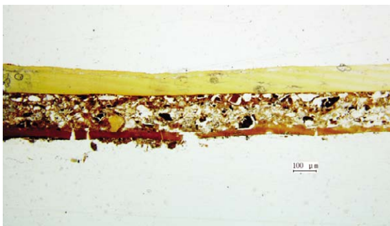
写真3 黒色漆片の顕微鏡写真
