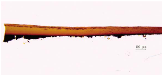
写真1 黒色漆片の顕微鏡写真
