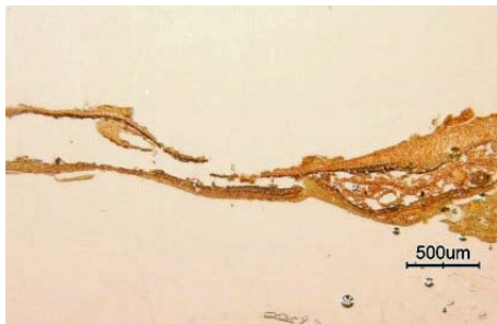
写真 43 試料 11 の塗膜断面
