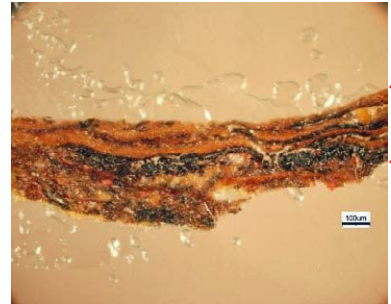
写真 12 試料 05 の塗膜断面(透過光)
