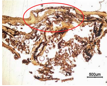
写真 26 試料 02 の塗膜断面 (赤丸部分は文様部)
