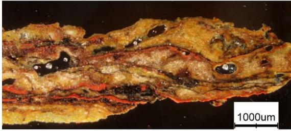
写真 29 塗膜断面（反射光）
