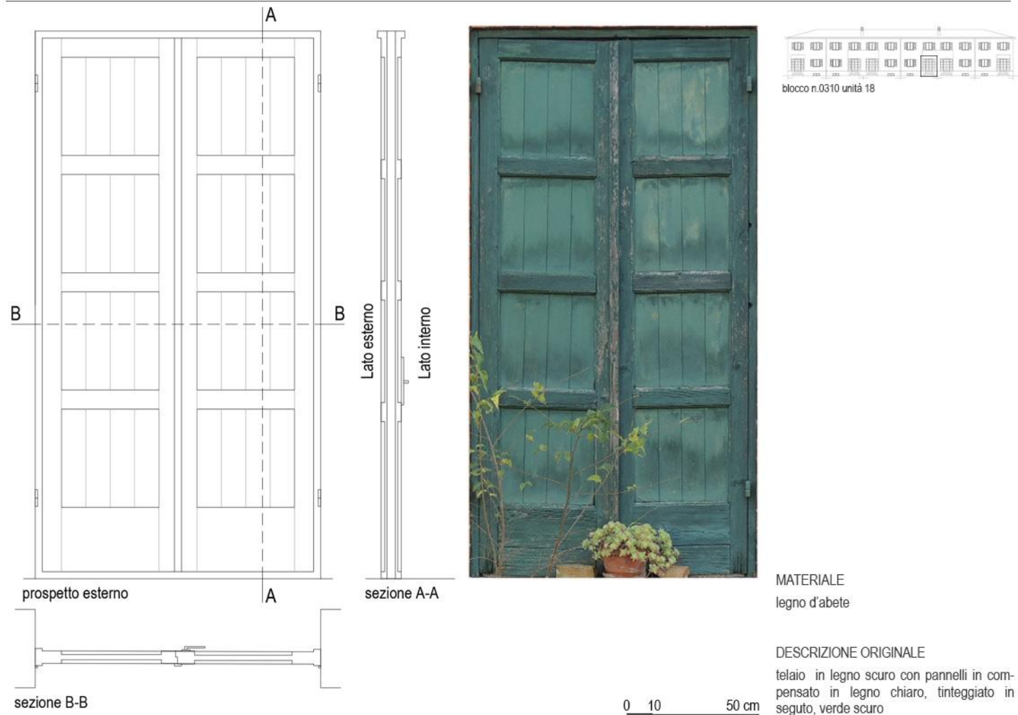
Figura 27_Case operaie 4-4bis, rilievo elemento oscurante della porta finestra.
