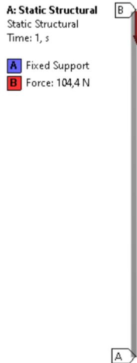
**Figura 32. Carga en Columna Ansys Workbench**
