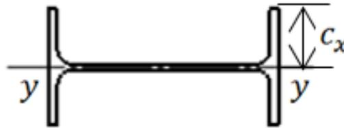
Figura 8. Módulo de sección de una viga en I que trabaja en el eje y-y
