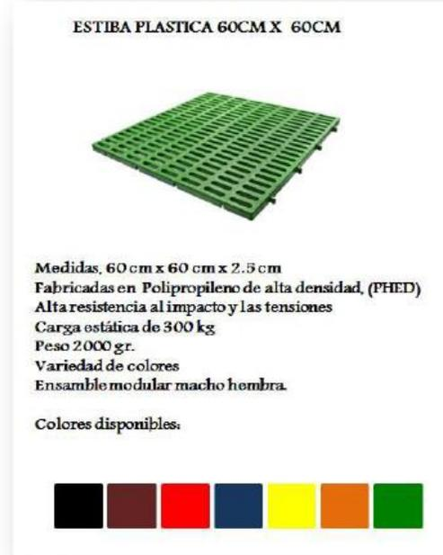
**Figura 26. Cotización de las estibas para la primera estructura**
