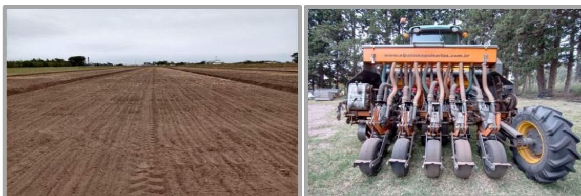
Figura 2: Izquierda: disposición de la siembra en tablones de 10 líneas. Derecha: sembradora neumática utilizada.
