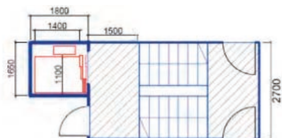
Ketjuhissi rungon ulkopuolelle
