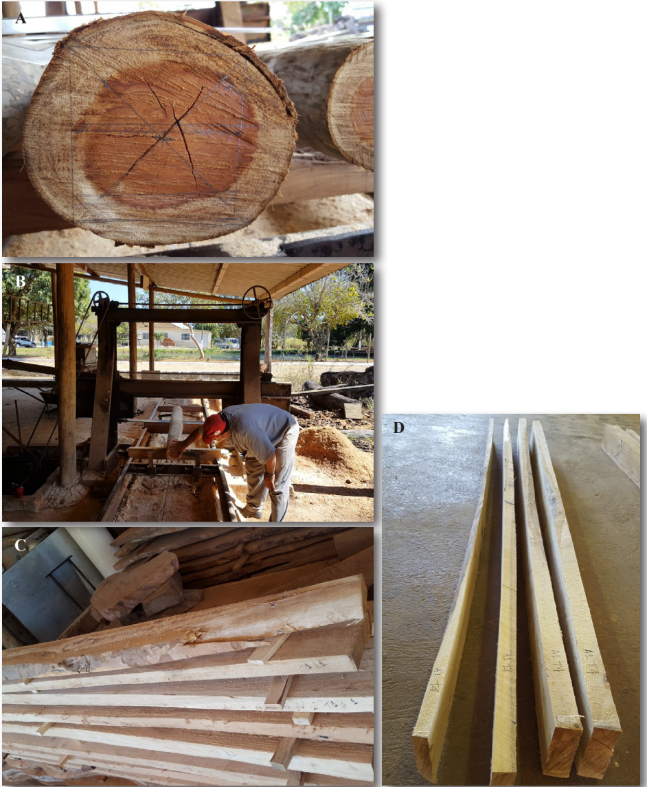
Figura 3. Demarcação de peças na tora para o desdobro (A), operação no engenho (B), peças desdobradas na marcenaria da Embrapa (C e D).
