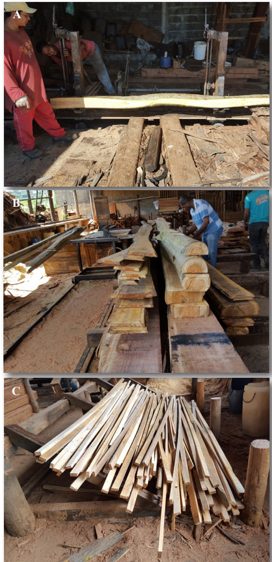
Figura 5. Operação na serra de fita (A), peças desdobradas (B), serragem final de ripas na serra circular (C).
