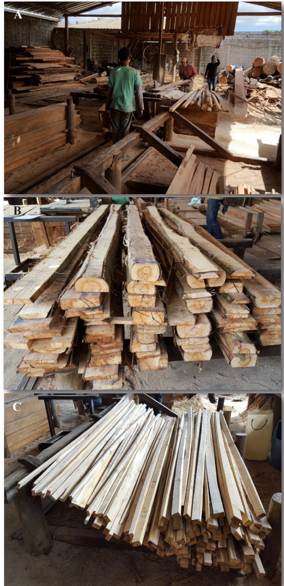
Figura 4. Operações na serraria (A), peças desdobradas (B), serragem final de ripões e ripas na serra circular (C).
