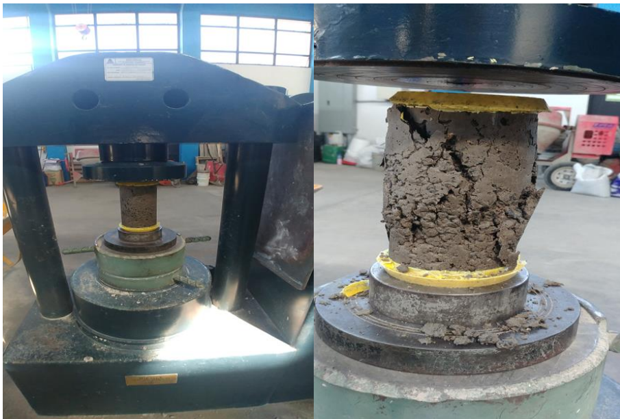
Figura 9. Ensayo de resistencia a compresión en cilindros de concreto
