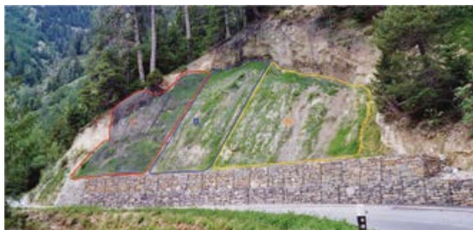
Slika 7. Testni poligon za evaluaciju geopletiva za zaštitu od erozije (testni poligon okrenut je prema jugozapadu te se nalazi na rijetko naseljenom području koje je izloženo ekstremnim promjenama vremena)
