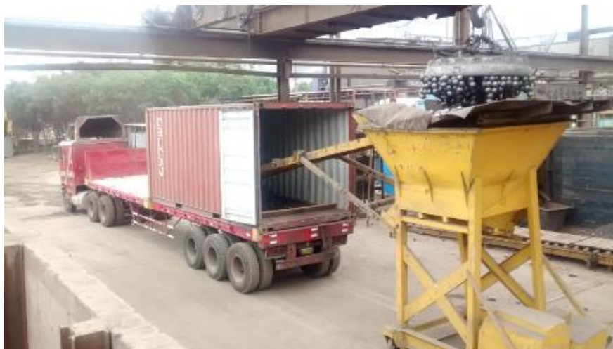
Imagen 4: Magneto capacidad 2.5Ton izaje.
