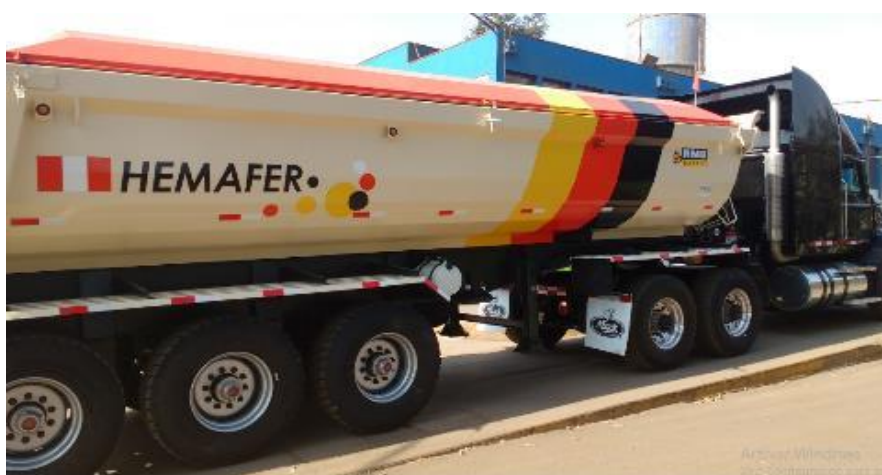
Imagen 5: Camión encapsulado para transporte de bolas capacidad 35 toneladas.
