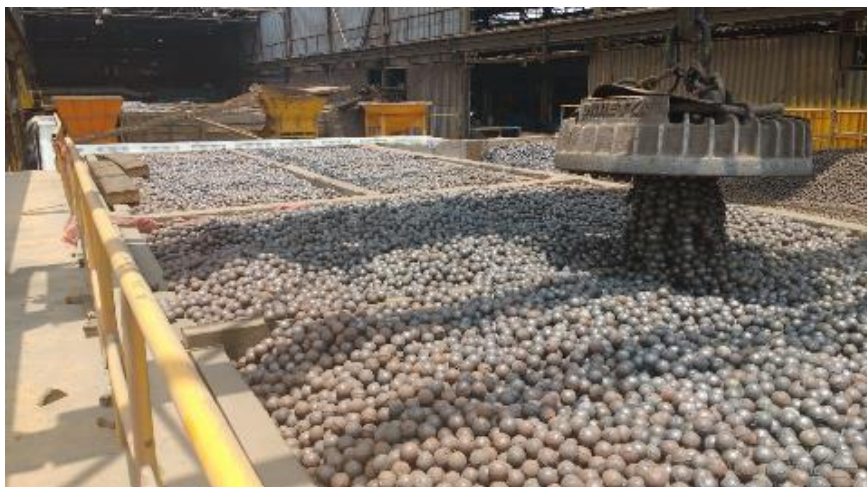
Imagen 2: Bines llenos de Bolas de acero y presencia del magneto de carga
