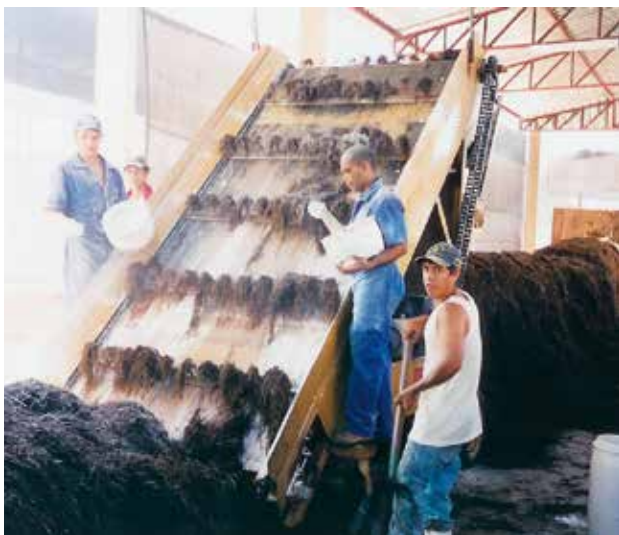
Figura 7. Revirada mecanizada da compostagem de Agaricus blazei .
