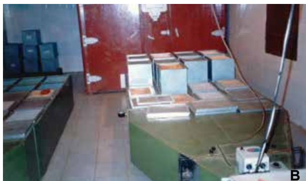
Figura 14. Modelos de desidratadores horizontais: a gás (A) e elétrico (B).
