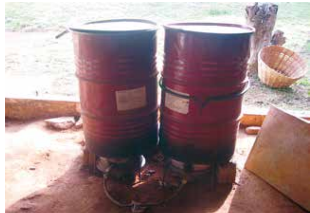
Figura 1. Pasteurizador (modelo artesanal).
