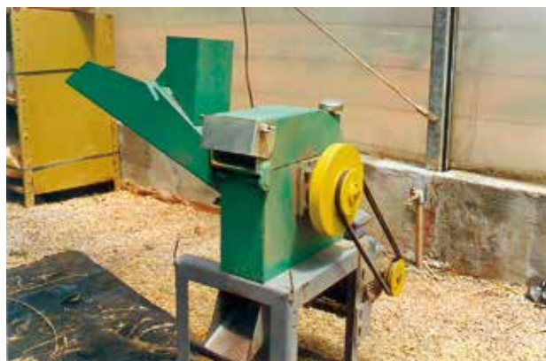
Figura 14. Triturador/picador para gramínea forrageira utilizado na técnica JunCao.
