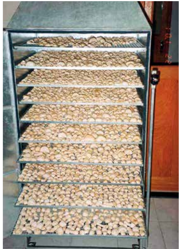
Figura 13. Desidratadora vertical elétrica com ventilação.
