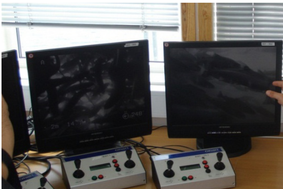
Figura 13. Sistema de controle visual com câmeras submersas instaladas no interior de tanques-rede de produção de salmão na Noruega para controle visual do consumo de ração.
