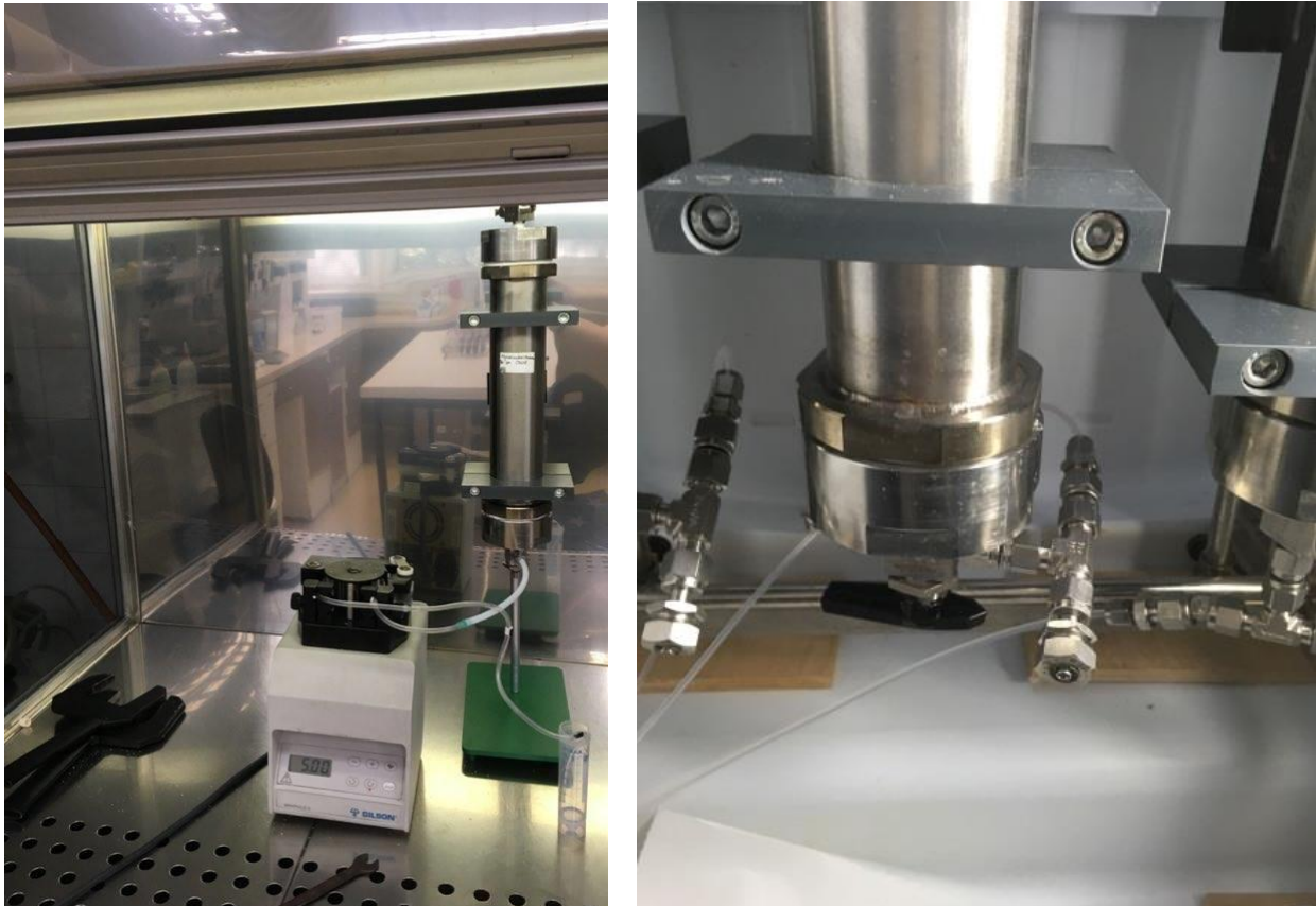
12. ábra: Az oszlopreaktorok beoltása (bal oldali fotó), illetve a mintavételi pont (befolyó ág) kialakítása (jobb oldali fotó)
