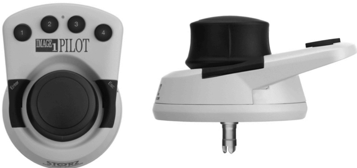
Abbildung 2: IMAGE1 Pilot TC 014 mit Benutzertasten 1-4 für programmierte Funktionen und 3D-Rad für Steuerung von Zoom, Fokus und ROI (modifiziert nach Quelle © KARL STORZ SE & Co. KG, mit freundlicher Genehmigung von Karl Storz, https://www.karlstorz.com/de/de/microscopy.htm?chunksize_documentation=15#hit3_6 , geprüft am 20.10.2020)
