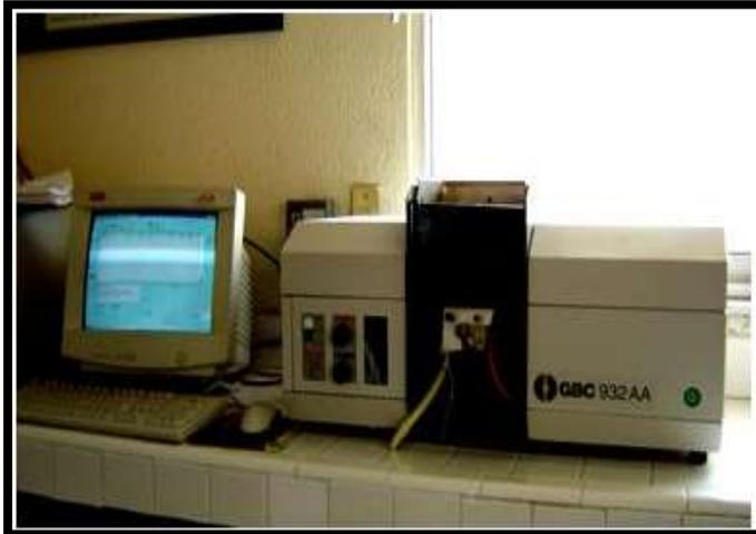
**Figura 11. Espectrómetro de Absorción Atómica**
