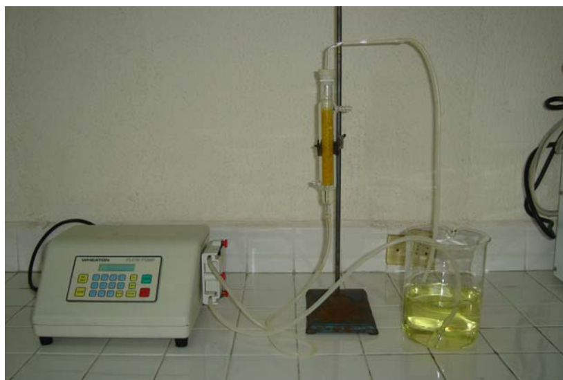
Figura 5. Columna de vidrio (Biorreactor de lecho fijo).
