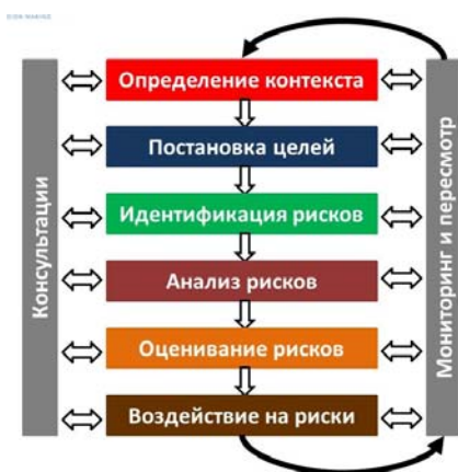
Рис. 1. Схема процессов управления рисками
