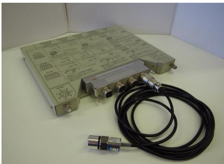
図 3.3 センサーインターフェース PCD-300 と圧力変換器 PGM-05KG
