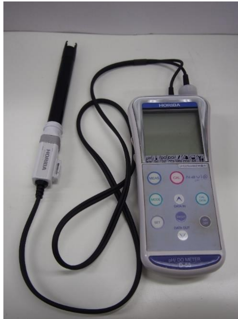
図 4.1 溶存酸素計 LAQUAD-55 と溶存酸素電極 5420-10D
